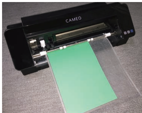
図3 カッティングプロッター。 A4のカラーケント紙をセットした状態。
